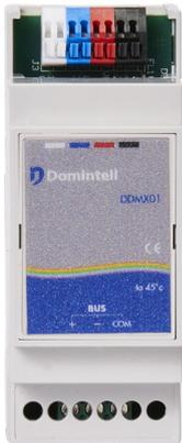
Le protocole DDMX512 est utilisé pour l'intégration de la gestion de l'illumination décorative LED RGBW de la façade, une solution habituelle et économique pour ce type d'applications. Au travers de la passerelle DDMX02 de Domintell, il est possible de contrôler les quatre canaux de couleurs LED (blanc, rouge, vert et bleu) qui permettent d'ornez dynamiquement les ouvertures de la façade du bâtiment avec les couleurs désirées pour chaque évènement.
